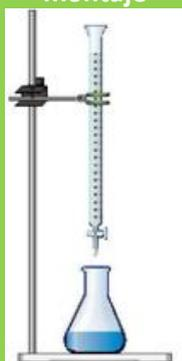
**1)** Llenar la bureta de **solución valorante de ácido clorhídrico HCl 0,10 M** (si es posible previamente calibrado o factorizado)..
